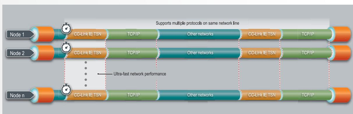
CC-Link IE TSN 對控制機器裝置的循環通訊賦予高度優先性、透過比情報通訊優先分配頻寬、所以可以簡易地架構即時性循環通訊控制機器裝置，與 IT 系統交換情報的網路環境。此外，善用與情報通訊混用的特點，以同一網路鏈結生產現場使用 UDP、TCP 通訊的機器裝置，例如，將視覺感測器、監視攝影機等數據以高精度方式儲存，也可以充份應用在監視、分析、解析等方面。
