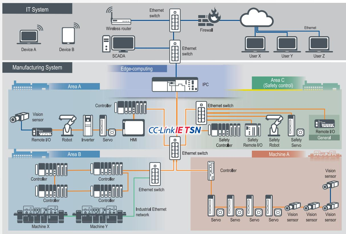
實現統合在同一網路架構下確保即時性控制通訊、其他開放網路通訊與 IT 系統情報通訊的智慧化工廠。
